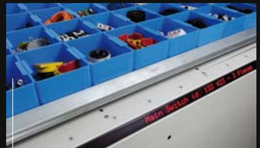
Una posición óptima del indicador muestra la descripción, situación y cantidad de artículos a recoger.
