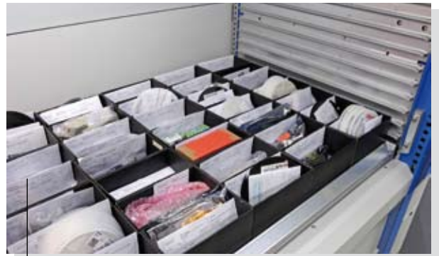
Bandeja con acabado antiestático (ESD) para el almacenamiento de material electrónico sensible.
