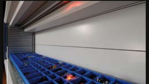
Particiones, divisores y cajas fáciles de utilizar para el libre movimiento del almacenamiento de alta densidad. Un puntero de luz opcional (recogida con luz, señalización con luz) proporciona un aumento de la precisión y la productividad.
