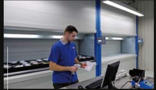
Integración rápida y sencilla de los escáneres de códigos de barras para la identificación de los pedidos, el picking y la validación.
